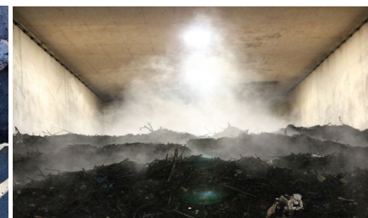
Biološka obrada u tunelu
