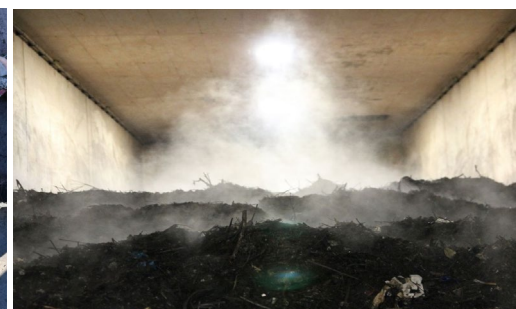
Biološka obrada u tunelu
